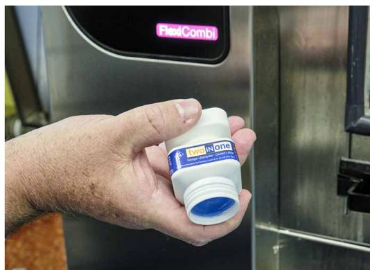
**Glanzleistung dank Kartuschenreinigung: Die versiegelnde Paraffinschicht löst sich bei 45 Grad auf und ermöglicht eine Zweifachreinigung inklusive Glanzprogramm.**
